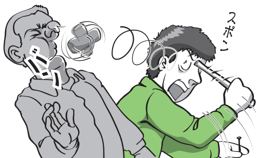
ハンマーの点検不足で頭部が抜けて起きた災害
